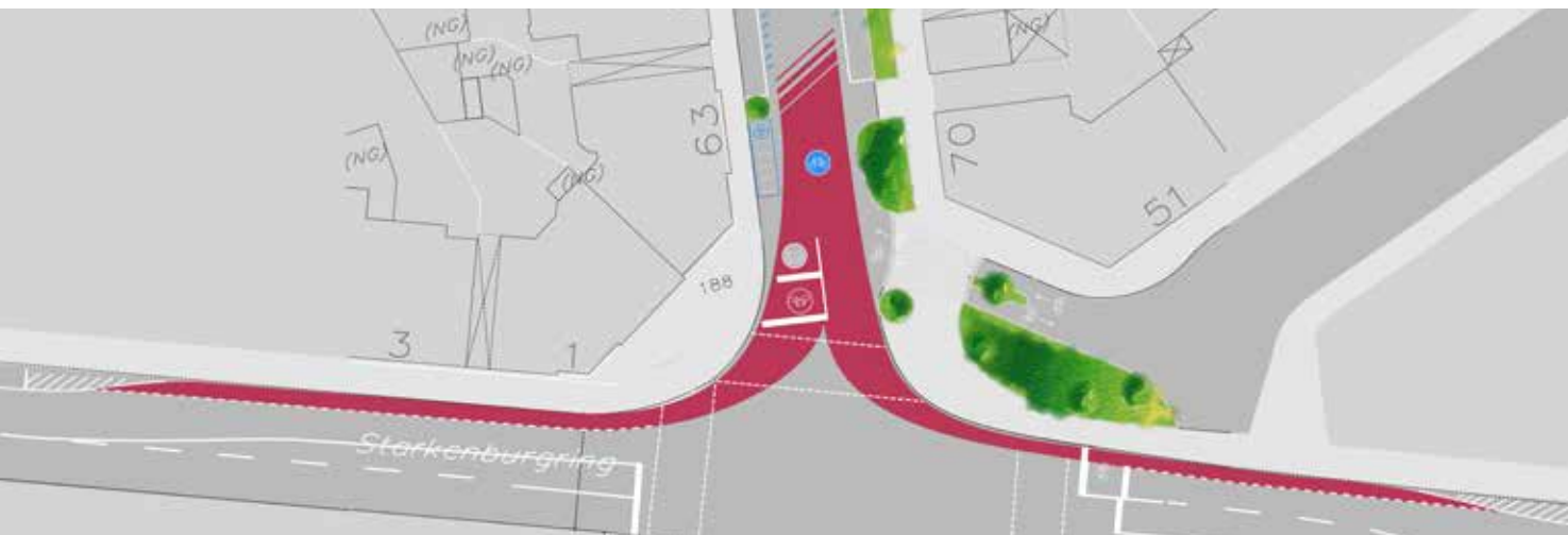
Abb. 110 Radfahrstreifen auf dem Friedrichsring dienen als Abbiegespuren für den Radverkehr
