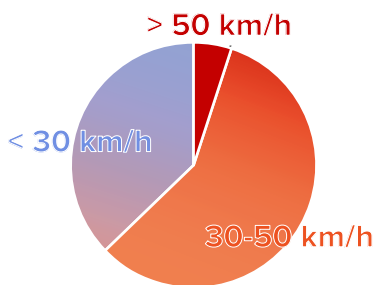
Abb. 16 Gemessene Geschwindigkeiten des motorisierten Verkehrs vor Einrichtung der Fahrradstraße nach J. Büttner
