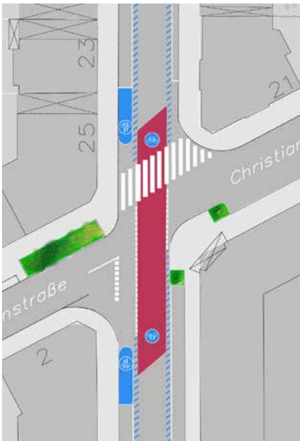
Abb. 78 Variante Knotenpunkt in 30er-Zone, Fahrradstraße hat Vorrang, zusätzliche Haltelinie, vorgezogene Gehwegnasen, Fahrradbügel umrahmt von blauer Kontur statt Sperrflächen
